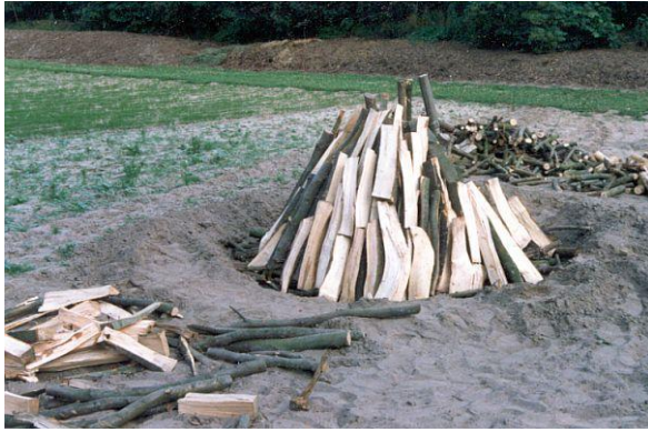
Stapelholz um den Zentralschacht
